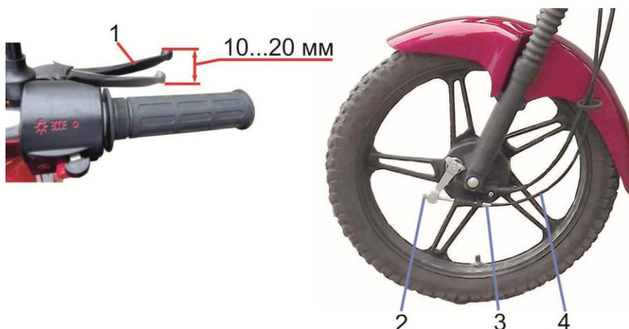
1 – рычаг управления тормозом переднего колеса; 2 – регулировочная гайка;
