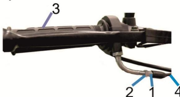
1 - регулировочный винт; 2 - контргайка;
