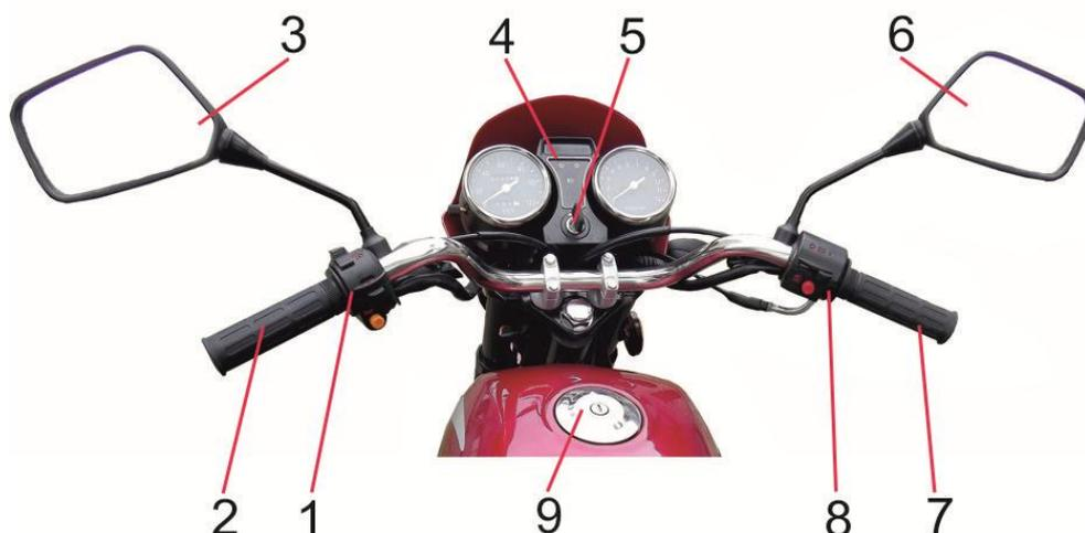
1 - блок переключателей на левой рукоятке руля; 2 – левая рукоятка руля; 3 – зеркало заднего вида; 4 – блок приборов; 5 – выключатель зажигания; 6 – зеркало заднего вида; 7 – правая рукоятка руля - рукоятка управления дросселем; 8 – блок переключателей на правой рукоятке руля; 9 - крышка топливного бака с замком.
