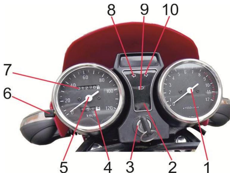
1 – тахометр; 2 – индикатор включенной передачи; 3 – выключатель зажигания; 4 – счетчик суточного пробега; 5 – спидометр; 6 – винт обнуления счетчика суточного пробега; 7 – одометр; 8 – контрольная лампа включения левого указателя поворота; 9 – контрольная лампа включения дальнего света фары; 10 – контрольная лампа включения правого указателя поворота.
