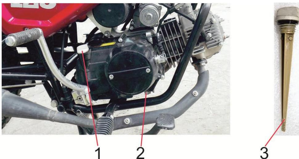
1 – пробка-щуп маслоналивного отверстия; 2 – сливная пробка;
