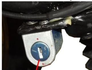
Замок блокировки рулевой колонки
