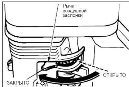
Рис.19 Установка рычага воздушной заслонки
