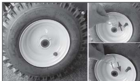
Рис.26 Установка шплинта на левом колесе
