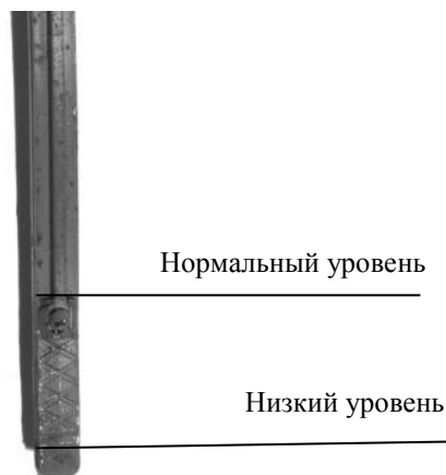
Рисунок 6 – Проверка уровня масла в корпусе редуктора
