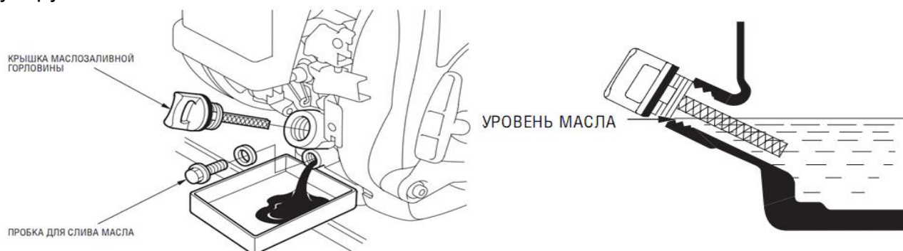
Рис.16 – Замена моторного масла
