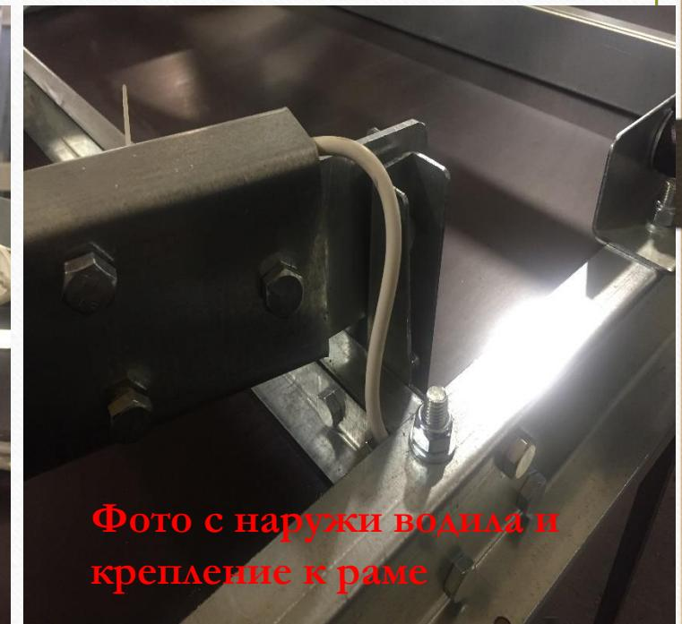
Электро провод фиксируем стяжкой к загибу водила, при этом провод уложить ровно, чтобы в движении не выпал из под загиба.
