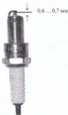
Зазор между электродами должен быть 0,6 - 0,7 мм.
