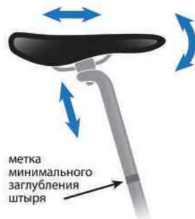
Наклон и перемещение седла (вперед/назад) регулируется соответствующим рожковым ключом на 12, 13 или 14, в зависимости от применяемых гаек. Отворачиваем две гайки, фиксирующие наклон и перемещение седла (вперед/назад) до ослабления фиксации седла. Устанавливаем удобное положение седла и закручиваем обе гайки с достаточным для надежной фиксации усилием.
