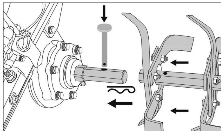
Рис. 6. Установка фрезы
