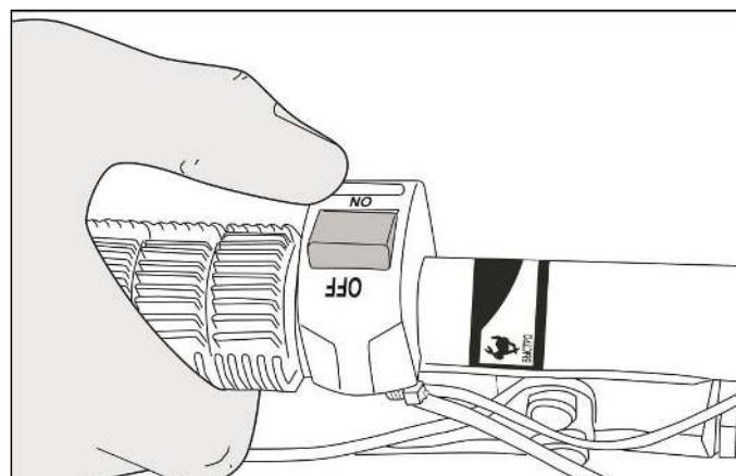
Рис. 23. Включение зажигания
