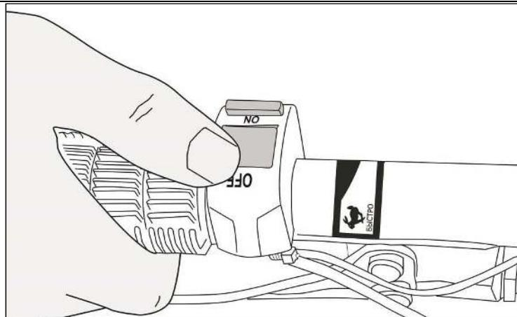
Рис. 31. Выключение зажигания
