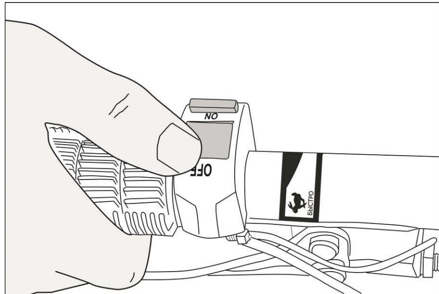
Рис. 33. Выключение зажигания
