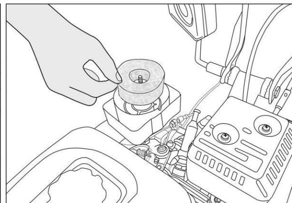
Рис. 22. Извлечение воздушного фильтра.
