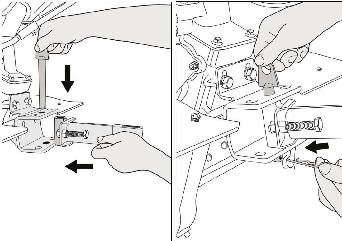
Рис.13. Установка и фиксации сцепки.
