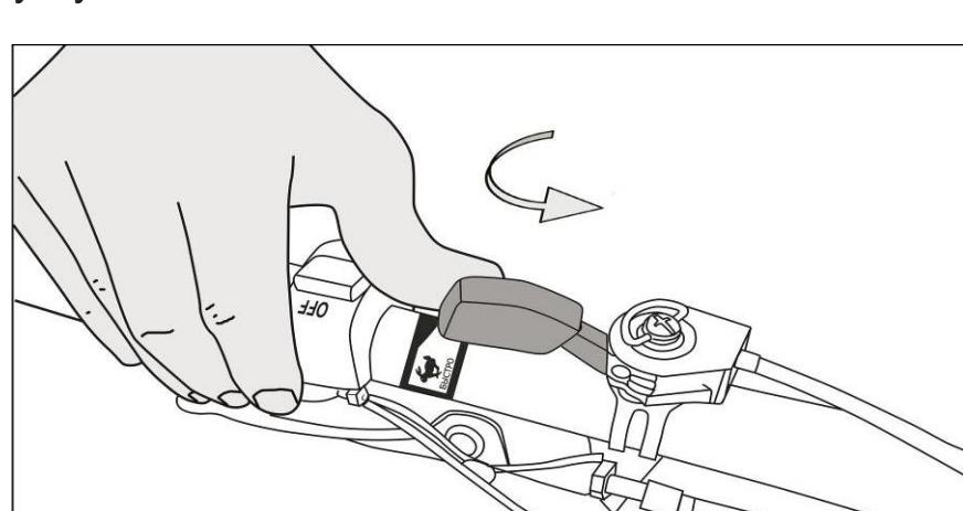
Рис. 28. Перевод ручки газа в максимальное положение
