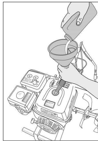
Рис. 20. Заливка бензина
