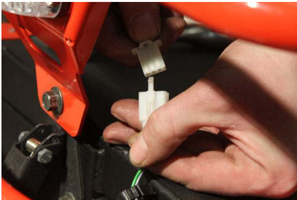
26. Разъединяем разъем заднего фонаря
