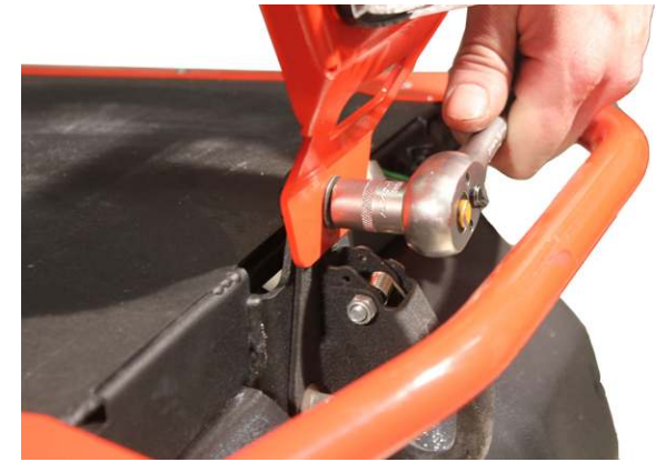
24. Снимаем лыжи с поворотного кулака. 25. Выкручиваем буксирную проушину.
