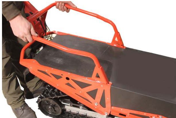
27. Снимаем багажник, потянув на себя и вверх
