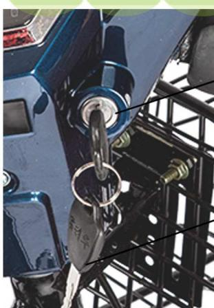
1. Замок включения/выключения электротрицикла.
